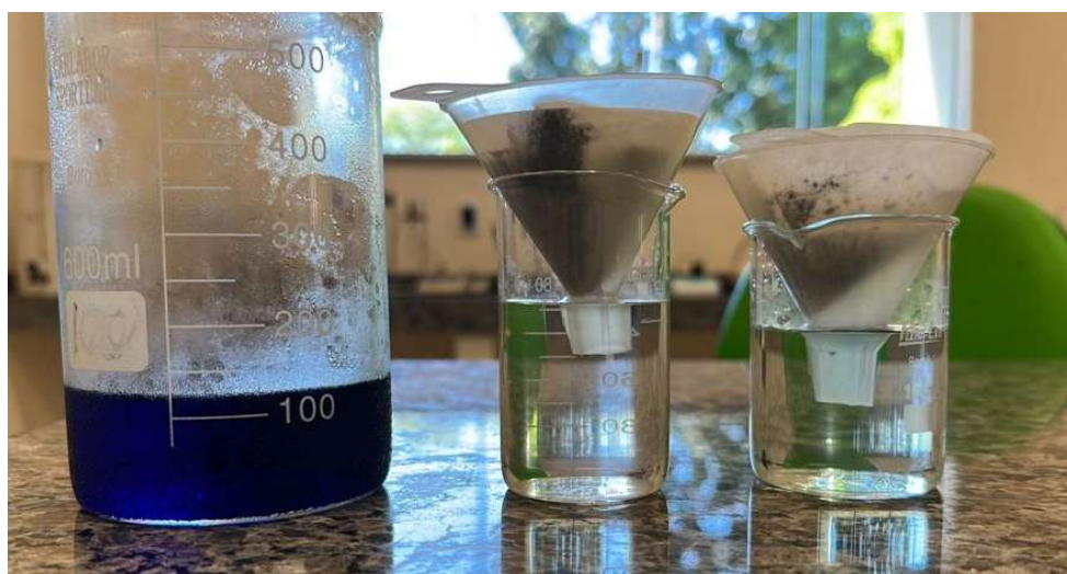
Figura 28 – Comparação visual entre solução de 100 \text{ mg.L}^{-1} de azul de metileno e solução pós adsorção usando CA-ZN-300-4.
